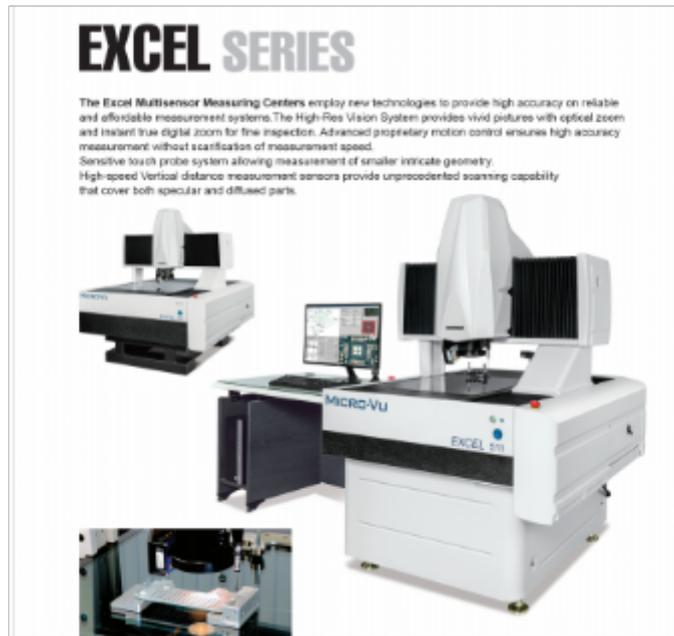
广泛应用于机械、电子、航空航天、模具、弹簧、齿轮、接线端子、电路板接点、五金塑胶、磁性材料、电子线路、元件、手表、小五金冲压业、矿石业、手机配件、家电制品、连接器、机械配件、精密夹治具、塑胶、五金、电脑周边行业等的测量。光学影像测量仪维护与保养1、仪器应放在清洁干燥的室内，避免光学零件表面污损、金属零件生锈、尘埃杂物落入运动导轨，影响仪器性能。2、仪器使用完毕，工作面应随时擦拭干净，比较好再罩上防尘套。3、仪器的传动机构及运动导轨、应定期上润滑油，使机构运动顺畅，保持良好的使用状态。4、工作台玻璃及油漆表面脏了，可以用中性清洁剂与清水擦拭干净。绝不能用有机溶剂擦拭油漆表面，否则，会使油漆表面失去光泽。5、仪器LED光源使用寿命很长，但当有灯泡烧坏时，请通知厂商，由专业人员为您更换。6、仪器精密部件，如影像系统、工作台、光学尺以及Z轴传动机构等均需精密调校，所有调节螺丝与紧固螺丝均已固定，客户请勿自行拆卸，如有问题请通知厂商解决。7、软件已对工作台与光学尺的误差进行了精确补偿，请勿自行更改。否则，会产生错误的测量结果。质量好的光学影像测量仪的找谁好？江苏检测光学影像测量仪案例
